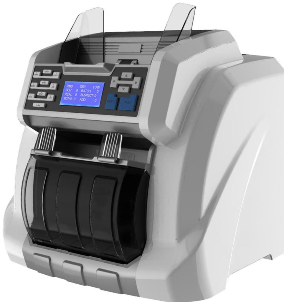
Conta, controlla e valorizza le banconote, miste, tramite triplice sensore composto da MT con controllo e **decodifica** del codice di sicurezza per la rilevazione delle banconote false, UV e MG per ulteriore conferma e IR per controllo dimensionale.
